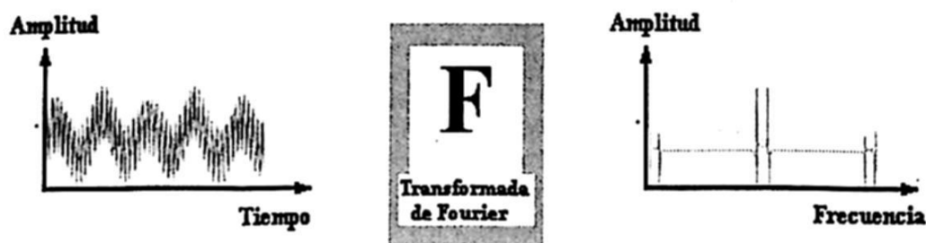
Fig. 1. Representación gráfica sobre el cambio de tiempo a frecuencia por la transformada de Fourier.
